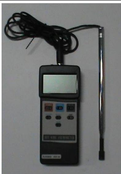
**Descrição:** Instrumento para medição de temperatura e velocidade do vento (ambientes internos).
