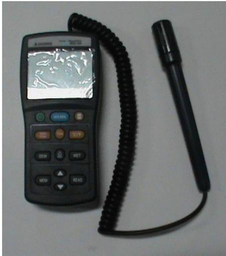
**Descrição:** Instrumento digital para medição de temperatura e umidade relativa.
