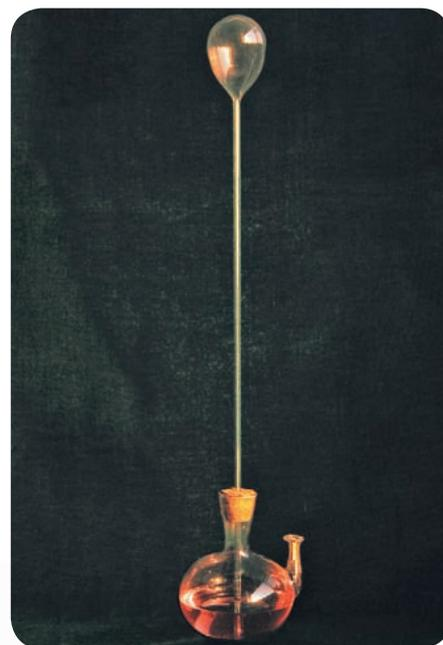
◀ O princípio de funcionamento do termoscópio é hoje utilizado em brinquedos como o da figura. Colocando-se a mão em contato com o recipiente inferior, o vidro se aquece e aumenta a pressão interna do vapor existente na parte de baixo. Como consequência, o líquido é “empurrado” para cima.
