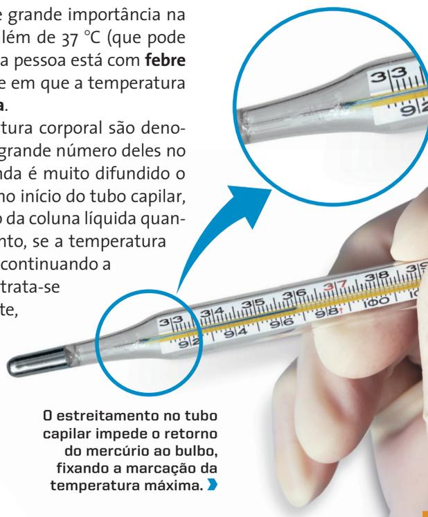
O estreitamento no tubo capilar impede o retorno do mercúrio ao bulbo, fixando a marcação da temperatura máxima. ➤
