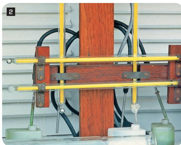
▶ Nas estações meteorológicas, os termômetros de máxima e de mínima ficam dispostos na horizontal. Os termômetros na vertical são destinados à determinação da umidade do ar.
