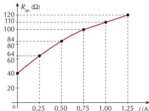
**Resposta:** O condutor é não linear e sua resistência aparente varia em função da intensidade de corrente elétrica segundo o gráfico acima.
