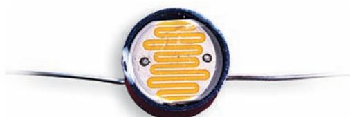
▶ Resistor fotossensível: sua resistência elétrica varia conforme a incidência da luz.
