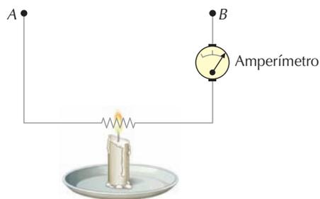
◀ **Figura 8.** Mantendo uma ddp constante entre A e B, o amperímetro indica uma diminuição na intensidade da corrente elétrica porque o aumento da temperatura é acompanhado de um aumento da resistividade do fio e, portanto, um aumento de sua resistência elétrica.
