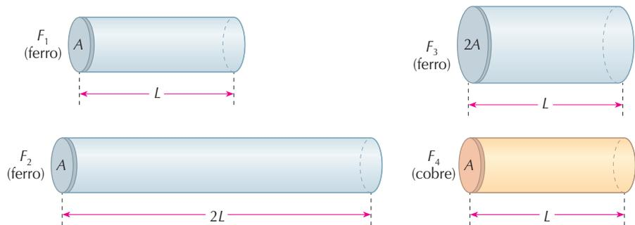
Figura 7. A resistência elétrica de um resistor em forma de fio cilíndrico depende do comprimento, da área da seção transversal, do material e da temperatura.
