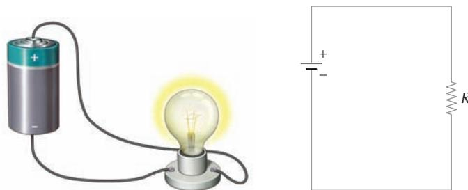
◀ **Figura 3.** Circuito elétrico formado por uma pilha (gerador), uma lâmpada e por fios de ligação de resistência elétrica desprezível. À direita, a representação esquemática do circuito.
