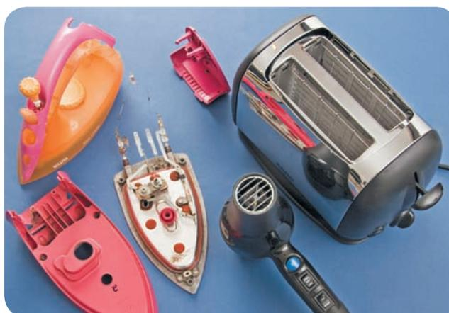
◀ Na torradeira, no secador e no ferro elétrico, a energia elétrica se converte em energia térmica (efeito Joule) quando a corrente elétrica passa pelo resistor do aparelho.
