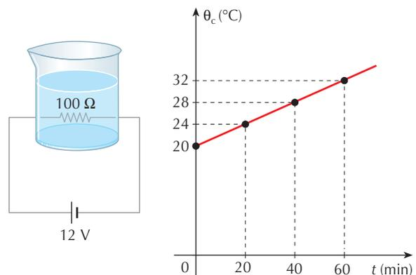
Dados o calor específico da água  $c = 4,2 \text{ J/g} \cdot ^\circ\text{C}$  e densidade da água  $\mu = 1,0 \text{ g/cm}^3$ , determine:
