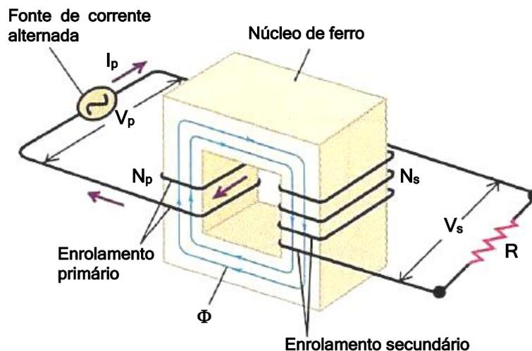
Figura 1: Esquema de um transformador (Sears & Zemansky).
