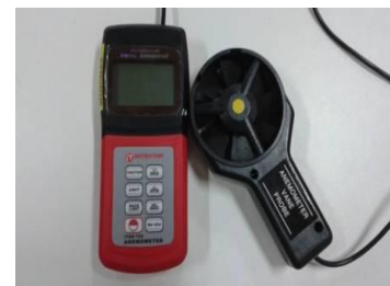
Anemômetro ITAN 720, 0,4 a 45 m/s, precisão +/- 0,2
