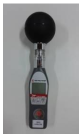
Termômetro de Globo ITWTG2000, de 0°C a 50°C, precisão +/- 0,6
